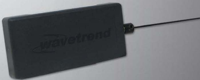
Alimentado por una batería de litio interna, el Tag Domino transmite una señal de radiofrecuencia en un intervalo de tiempo predefinido. Es desarrollado para la identificación y control de activos. Tiene tamaño compacto, es hecho en PVC y sellado por ultra-sonido.
