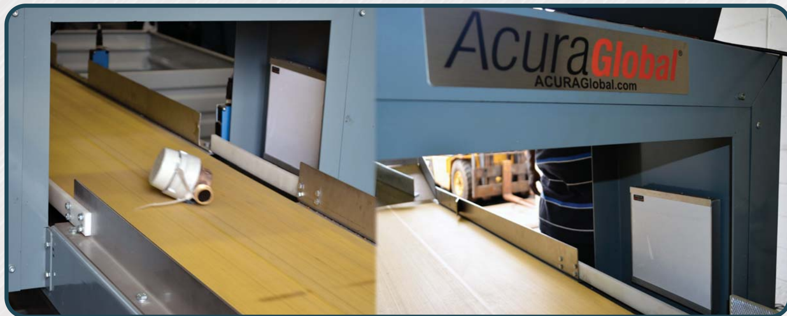
Esteras de conferencia de medidores de agua con solución RFID ACURA
